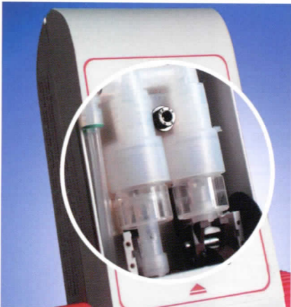
通過旋轉大型拇指輪和獲得專利的雙活塞泵可連續抽取滴定液。
